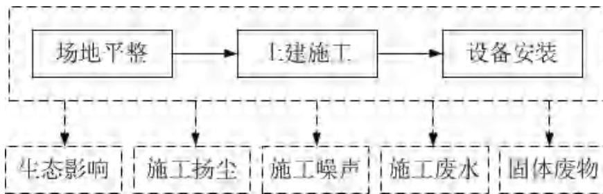
图 4-1 变电站建设期产污环节
